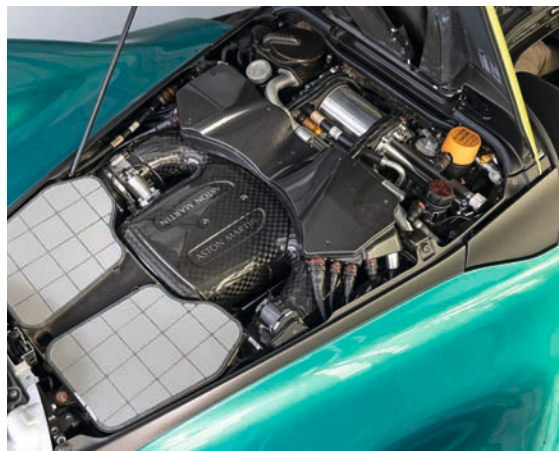
Der 6,5-Liter-V12-Sauger stammt von Cosworth, die Hybridbatterie von Rimac und das Getriebe von Ricardo.
