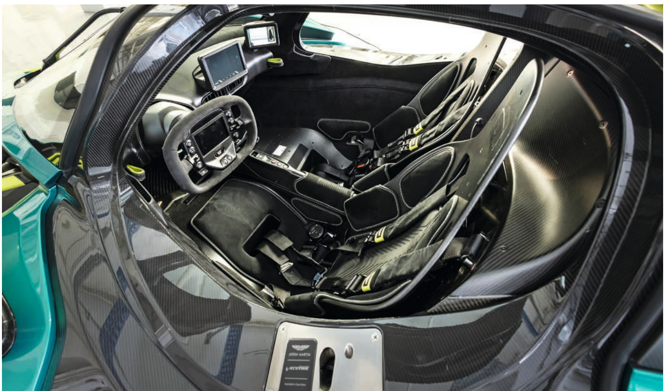
Die Karbonschalensitze im Karbon-Monocoque wiegen nur acht Kilogramm. Kameras und Monitore im Cockpit ersetzen die Aussenspiegel.
